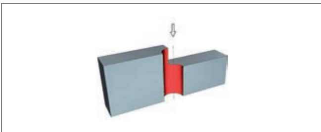
Anbohren auf einer Kante
