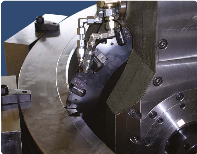
Fertigfräser mit formgeschliffenen Wendeschneidplatten Innenring Modul 10; Werkstoff: 42CrMo4 Schlichtbearbeitung
