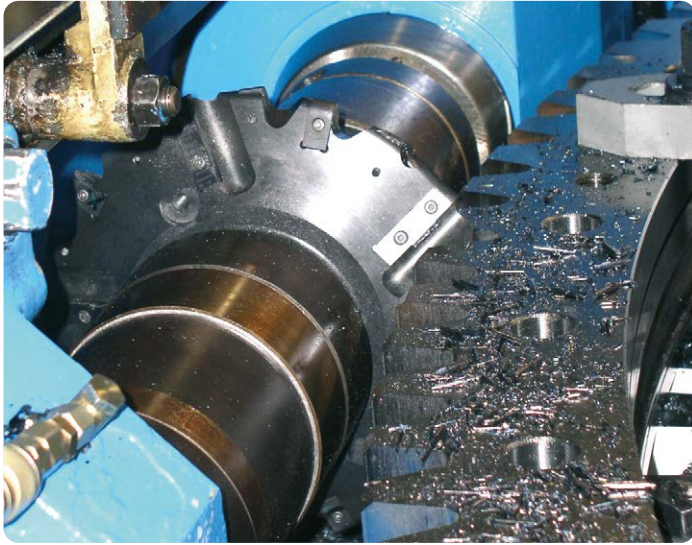
Fertigfräser mit formgeschliffenen Wendeschneidplatten Außenring Modul 20; Werkstoff: 42CrMo4 Schlichtbearbeitung (2. Schnitt)
