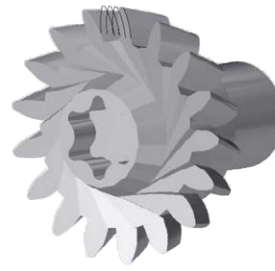
Komplett nachgeschliffenes Werkzeug / Completely reground tool
