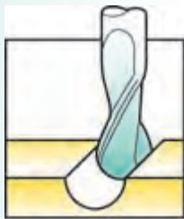
PRECISE GROOVING R +/- 0,01mm
