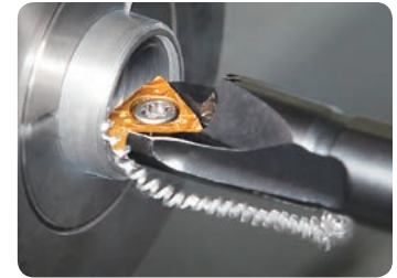
F1 chipbreakers evacuate chips BACKWARD (S-STUC style shown)
