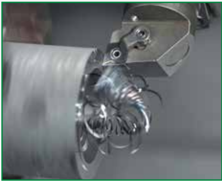
Insert without Chipbreaker
