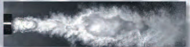
高速カメラによる水中噴射状態 High Speed Photograph of Submerged Water Jet
