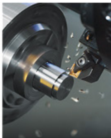
Werkzeuge und Wendeschneidplatten zum Drehen und Gewindedrehen Tooling and indexable inserts for turning and threading Utensili ed inserti di tornitura e filettatura
