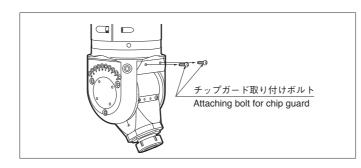
③チップガードを防塵カバーに取り付けます。防塵カバー取り付けボルトで締め付けます。次にチップガード取り付けボルトを締め込み、固定してください。
