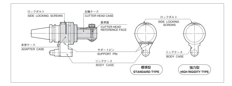
②機械にアングルヘッドを取り付けた状態で、サポートピンを両側から完全に抜き取ってください。2本のロックボルトを少しだけ緩め、角度の調整を行います。似め参照(強力型にはサポートピンはありません。)角度の微調整は、角度調整用バーを本体ケースの横穴に挿入して行ってください。ロックボルトをゆるめすぎますと、リングケースと本体ケースの間に**すき間**ができるおそれがありますので注意してください。また、2本の角度調整用バーを180°対角に挿入すると、微調整が行いやすくなります。ロックボルトを締め付ける場合は、付属のLレンチで均等に締め付けてください。
