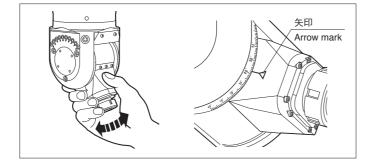
スピンドルケースの移動の際は素早く動かしたり、防塵カバーをおさえたりしないでください。防塵カバーの作動不良を起こす場合があり、破損する恐れがあります。また、スピンドルケースの移動時に防塵カバーが折れ曲がりそうな場合はスピンドルケースを少し戻してスムーズに動くことをご確認ください。
