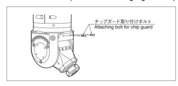
②チップガードを防塵カバーにかぶせ、その上からチップガード取り付けボルトを締め込み、チップガードを固定します。
