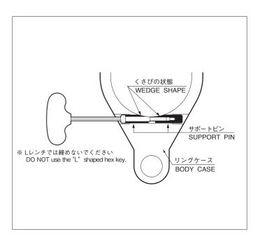
④角度を変更するためにサポートピンを抜く時は、まずボルトを完全 にゆるめボルトの頭部を叩いて片方のサポートピンを抜いてくださ い。次に反対側より角度調整用バーを差し込み、同じ様に叩いても う一方のサポートピンも抜いてください。
