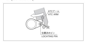
・ ATC作動中に、ATCアームが位置決めピンに干渉しないかを確認し ・ ATC作動中に、ATCアームが位置決めブロックに干渉しないかを確 認してください。
