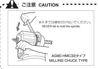
1本のレンチだけで締め付けますと、ギヤなどに負担が掛かりますので、 絶対にしないでください。また、Lレンチをパイプなどで延長して締め 付けたりは絶対にしないでください。
