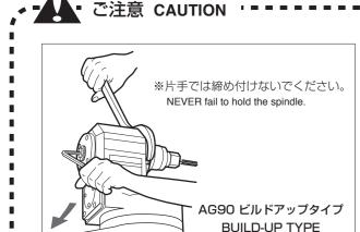
1本のレンチだけで締め付けますと、ギヤなどに負担が掛かりますので、 絶対にしないでください。また、Lレンチをパイプなどで延長して締め 付けたりは絶対にしないでください。
