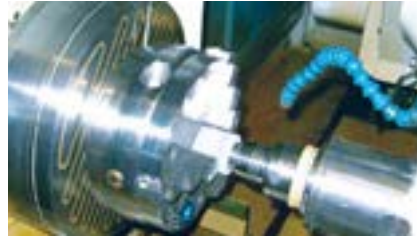
Abb. | Fig. 2 Innenspannung | I.D. Clamping
